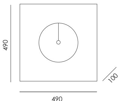
2x Alogena/Halogen/Halogène R7s 77mm
