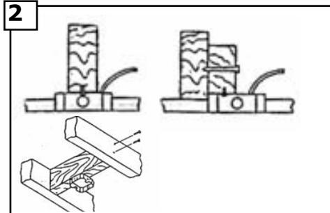
**2** Avant d'installer ce ventilateur, vérifiez que la boîte de sortie de courant est bien connectée à la charpente du bâtiment. Pour éviter les risques d'incendie, d'électrocution ou d'accident, montez le ventilateur uniquement à une boîte de sortie de courant ou à un système de support pouvant supporter le poids du ventilateur. L'ensemble de montage doit pouvoir supporter au moins 15,8 kg.)
