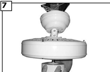
**7** Suspendez le ventilateur monté depuis le support de suspension installé au plafond à l'étape précédente. Assurez-vous que le ventilateur est bien droit. Faites pivoter le ventilateur jusqu'à ce que la languette du support de suspension s'engage dans la fente de la rotule de la tige verticale. Ceci empêche le bâti du ventilateur de pivoter lorsque les lames sont en mouvement.
