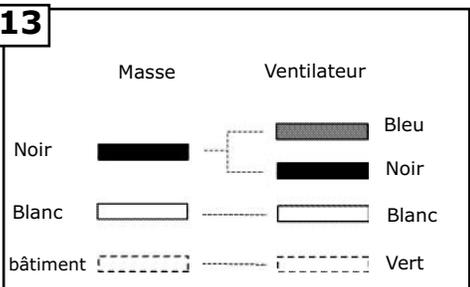
**13** Connectez les fils noir et bleu provenant du ventilateur au fil noir ou (chargé) provenant du bâtiment. Connectez le fil blanc provenant du ventilateur au fil blanc (neutre) provenant du bâtiment. Connectez les conducteurs de masse provenant du support de suspension et de la tige au conducteur de masse du bâtiment. Reportez-vous à la section relative aux Conseils de sécurité de ce guide.
