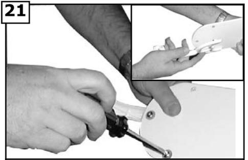
Placez les porte-pales sur les pales en alignant les trous de chaque porte-pale avec les trous de chaque pale. Assurez-vous que le côté de la pale que vous sélectionnez est tourné vers le bas. Installez 3 vis et les rondelles en fibres à l'arrière de la pale comme indiqué. Serrez les vis à fond. Répétez ce processus 4 fois jusqu'à ce que vous ayez assemblé toutes les pales.
