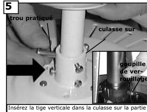
**5** Insérez la tige verticale dans la culasse sur la partie supérieure du bâti du ventilateur. Alignez le trou pratiqué sur la tige verticale avec le trou pratiqué dans la culasse. Insérez la goupille à travers la culasse et la tige verticale jusqu'à ce que la pointe réapparaisse de l'autre côté. Installez la goupille de verrouillage.
