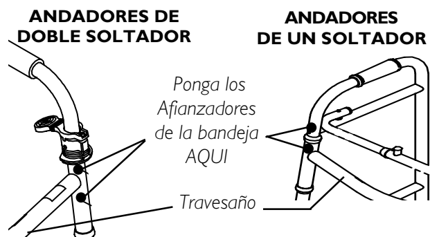
FIGURA 1 - INSTALANDO LOS AFIANZADORES DE LA BANDEJA
