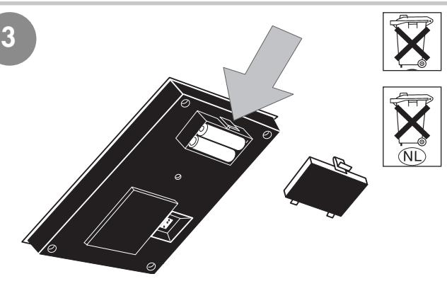
Eine schwache oder erloschene Computeranzeige macht einen Batteriewechsel erforderlich. Der Computer ist mit zwei Batterien ausgestattet. Nehmen Sie den Batteriewechsel wie folgt vor:
