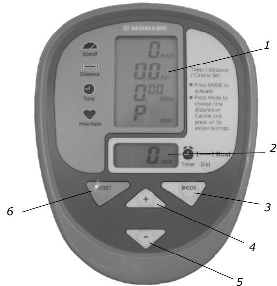
Fig: Display 1) Main display 2) Lower display 3) MODE-key 4) (+) -key 5) (-) -key 6) RESET-key
