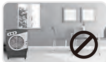
Ambiente con puertas y ventanas cerradas.
