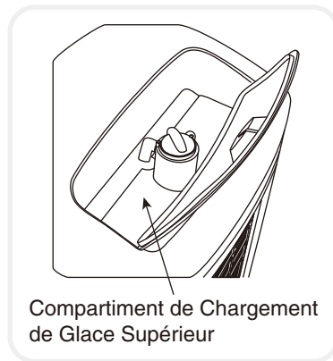
Porte de Remplissage D'eau
